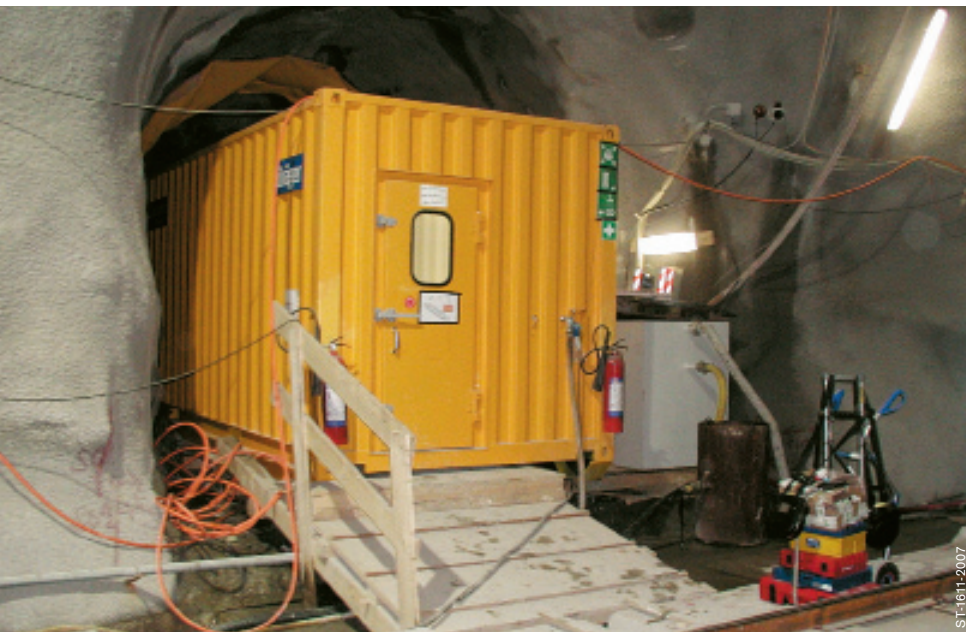
Diese autonome Rettungskammer bietet Schutz vor Rauch und Partikeln.
