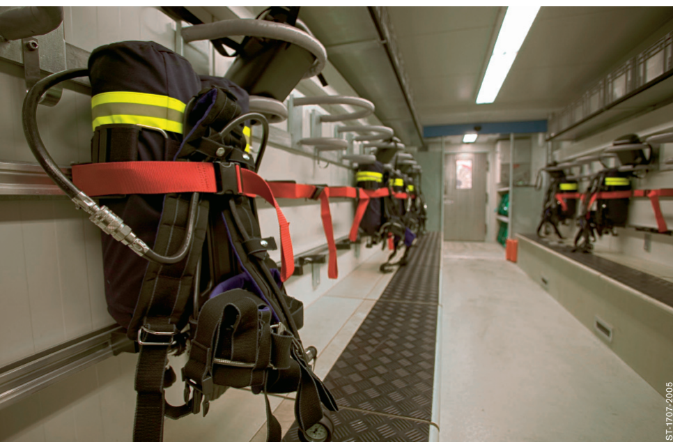
Die Rettungskammer ist gasdicht: Im Inneren kann aufgeatmet werden.
